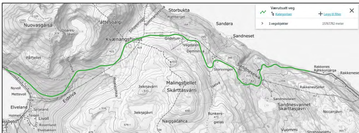
Figur 23: Oversiktskart over Kvænangsfjellet. Grønn linje viser strekningen som klassifiseres som værutsatt veg ifølge NVDB.
